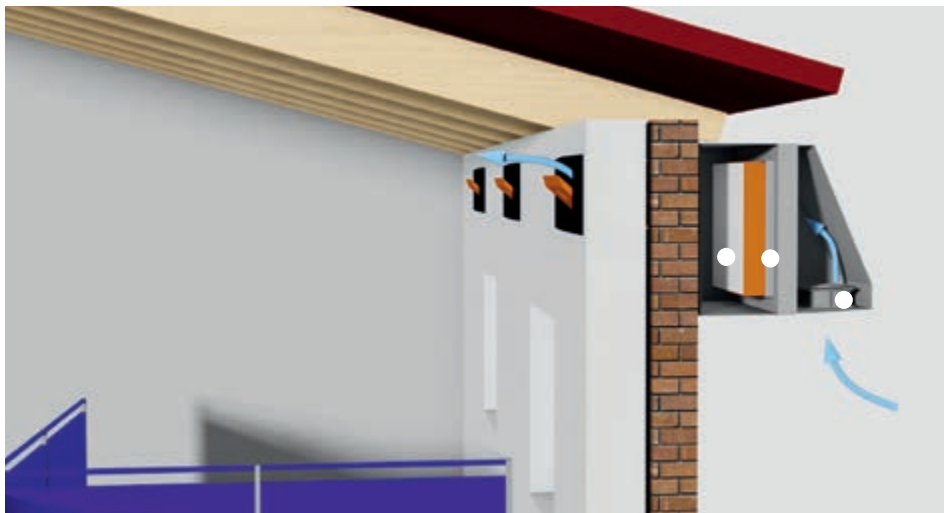
Схема роботи APT 1500 для децентралізованої подачі повітря через стінний клапан CL 1200
